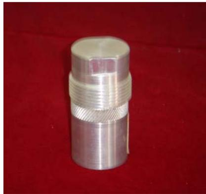
防水抗高冲击记录仪主要用于战斗部或鱼雷入水试验,测量入水过程中的过载等信号,其采样频率可以在 40kHz 以下,记录深度达到 512K,单通道,入水过载的范围在 1000g~20000g 之间。其组成基本上同一体化侵彻过载记录仪。
