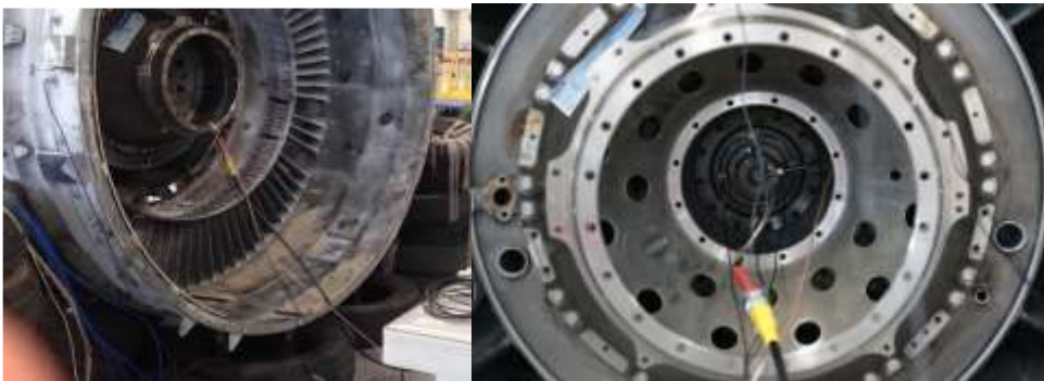
某型航空发动机旋转激振试验
