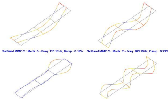
某赛车车架采用两个激励器激励的 EMA 试验模态分析一、三、五、七阶模态识别结果
